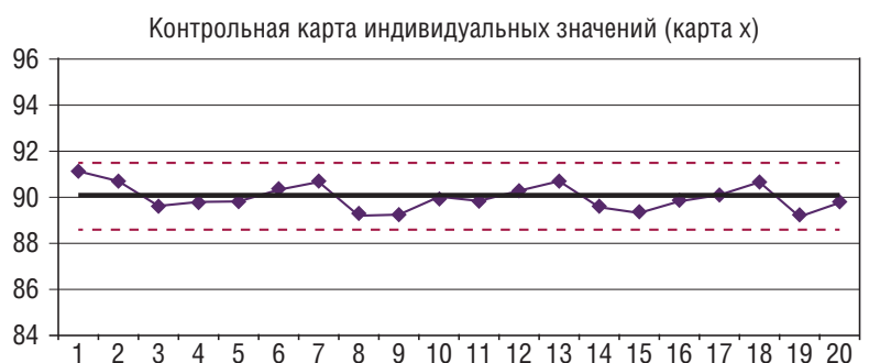
Рис. 4. Карта индивидуальных значений для показателя «Процент инцидентов, решённых вовремя». Вариант 3. Уменьшение разброса показателя. Стабильный процесс.
